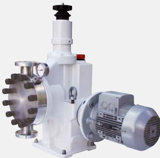
Pompa XL con testata in PVDF a singola membrana idraulica. Regolazione automatica della portata tramite servocomando elettrico che, grazie alla protezione IP66 ed alla resistenza anticondensa, risulta particolarmente adatto ad installazioni in condizioni climatiche difficili quali ambienti salini e/o desertici con elevata umidità e notevoli variazioni della temperatura.
